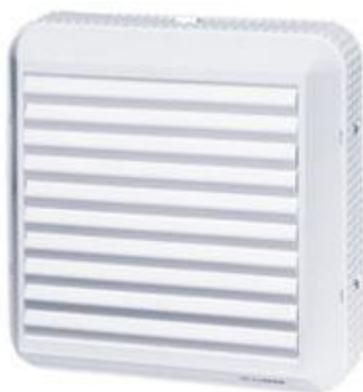
Оконные осевые вентиляторы Ventilor с автоматически или вручную открывающимися жалюзи предназначены для непосредственного (без воздуховода) удаления или подачи воздуха. Вентиляторы изготавливаются из пластмассы светлых тонов и устанавливаются на стекле или на панели. Конструкция наружной решётки предусматривает защиту от атмосферных осадков. Все модели этой серии выпускаются в брызгозащищенном исполнении (степень защиты IP X4).
